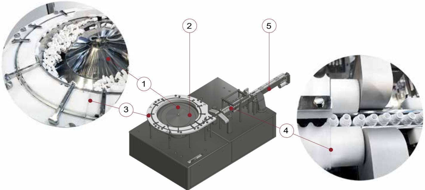
Die zentrale Drehscheibe (1) sowie die inneren Bauteile, die direkt mit den Behältern in Berührung kommen, sind aus Edelstahl AISI 316 gefertigt. Auch die Schneckenschrauben (4) und Führungen (3), die direkt mit den Behältern in Berührung kommen, sind aus weißem Polyoxymethylen (POM) hergestellt. Die kantenfreie Oberfläche eignet sich ausgezeichnet für Produkte der Pharmaindustrie. Alle Schweißnähte sind durchgehend und elektropoliert.
