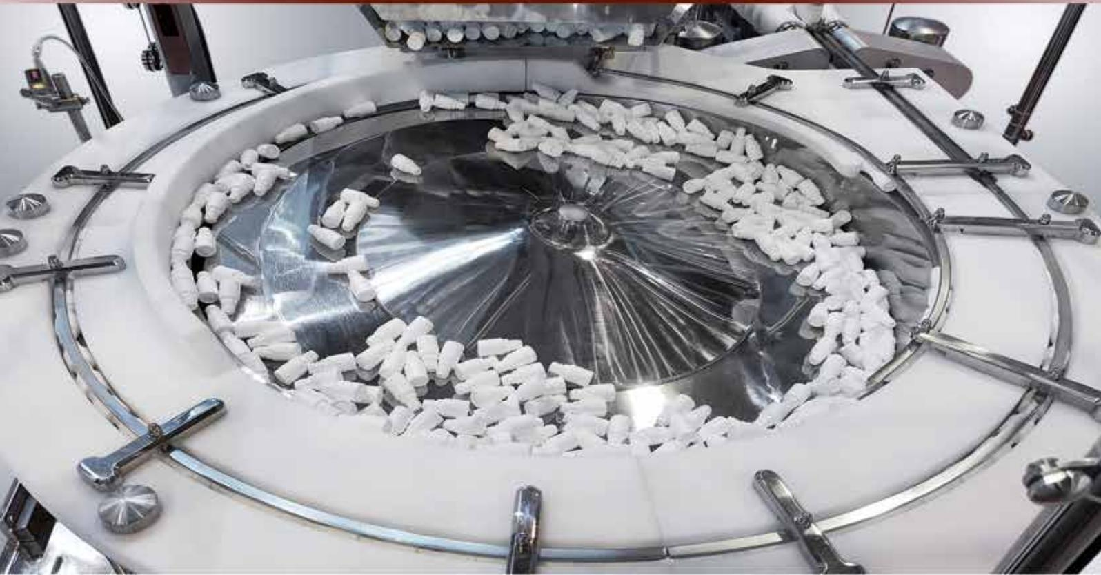
ASEPTIC ist eine Maschine für Kleinstgebinde im pharmazeutischen Bereich (Nasensprays, Augentropfen, etc...).
