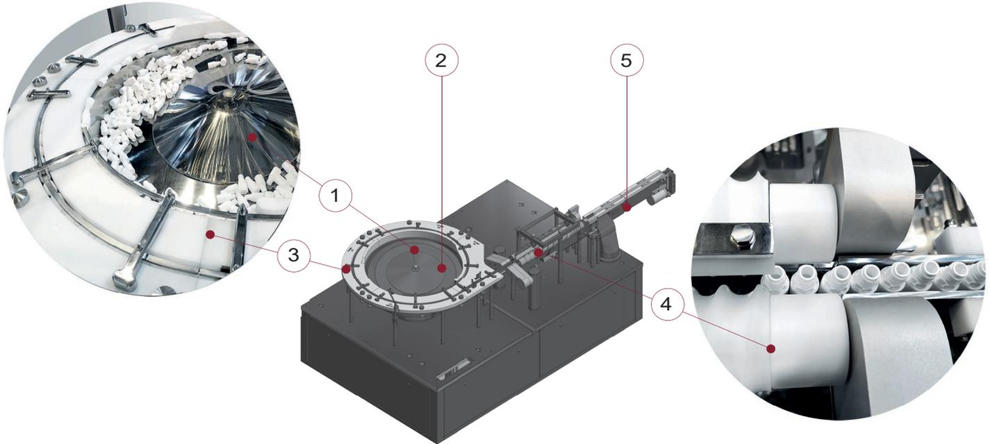
Il mozzo centrale (1) e le parti interne a contatto diretto con i contenitori sono realizzati in acciaio inox AISI 316, mentre le viti senza fine (4) e le guide (3) sono in polioossimetilene (POM) bianco. La finitura superficiale è priva di bordi, ideale per il settore farmaceutico. Tutte le saldature sono continue ed elettrolucidate.
