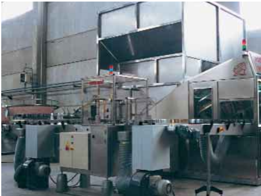
Silo Posisilo, posicionador Posimat y orientador Giramat.
