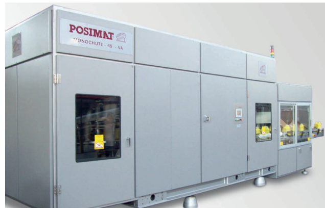
Cabina in acciaio plastificato per il riordinatore modello MONOCHUTE-45 con orientatore rotativo incorporato in monoblocco
