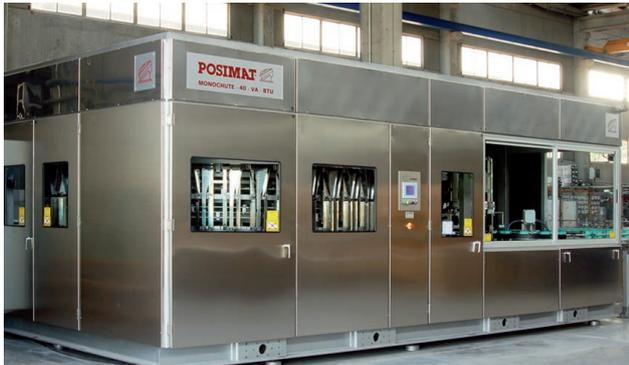
Modello di riordinatore **MONOCHUTE-40** con sistema di cambio di formato **POSIFLEX-A**, **BTU\*** incorporato in monoblocco e cabina in acciaio inossidabile
