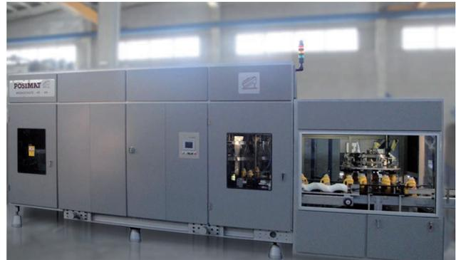
Modello di riordinatore **MONOCHUTE-45** con sistema di cambio di formato **POSIFLEX-A** e **Orientatore rotativo** incorporato in monoblocco
