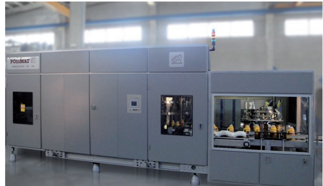
Aufrichter vom Typ MONOCHUTE-45 mit POSIFLEX-A vollautomatischer Formatumstellung und integriertem Flaschenausrichter im Rundlauf im Monoblock
