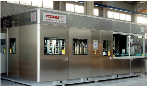
Modelo de posicionador MONOCHUTE-40 con sistema de cambio de formato POSIFLEX-A , BTU* incorporada en monoblock y cabina de acero inoxidable
