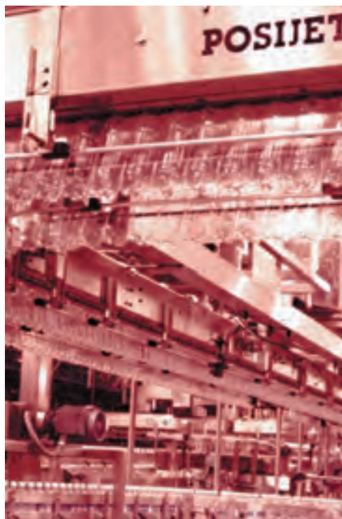
Vue d'un convoyeur à air POSIJET travaillant à 1.200 bouteilles / mn.
