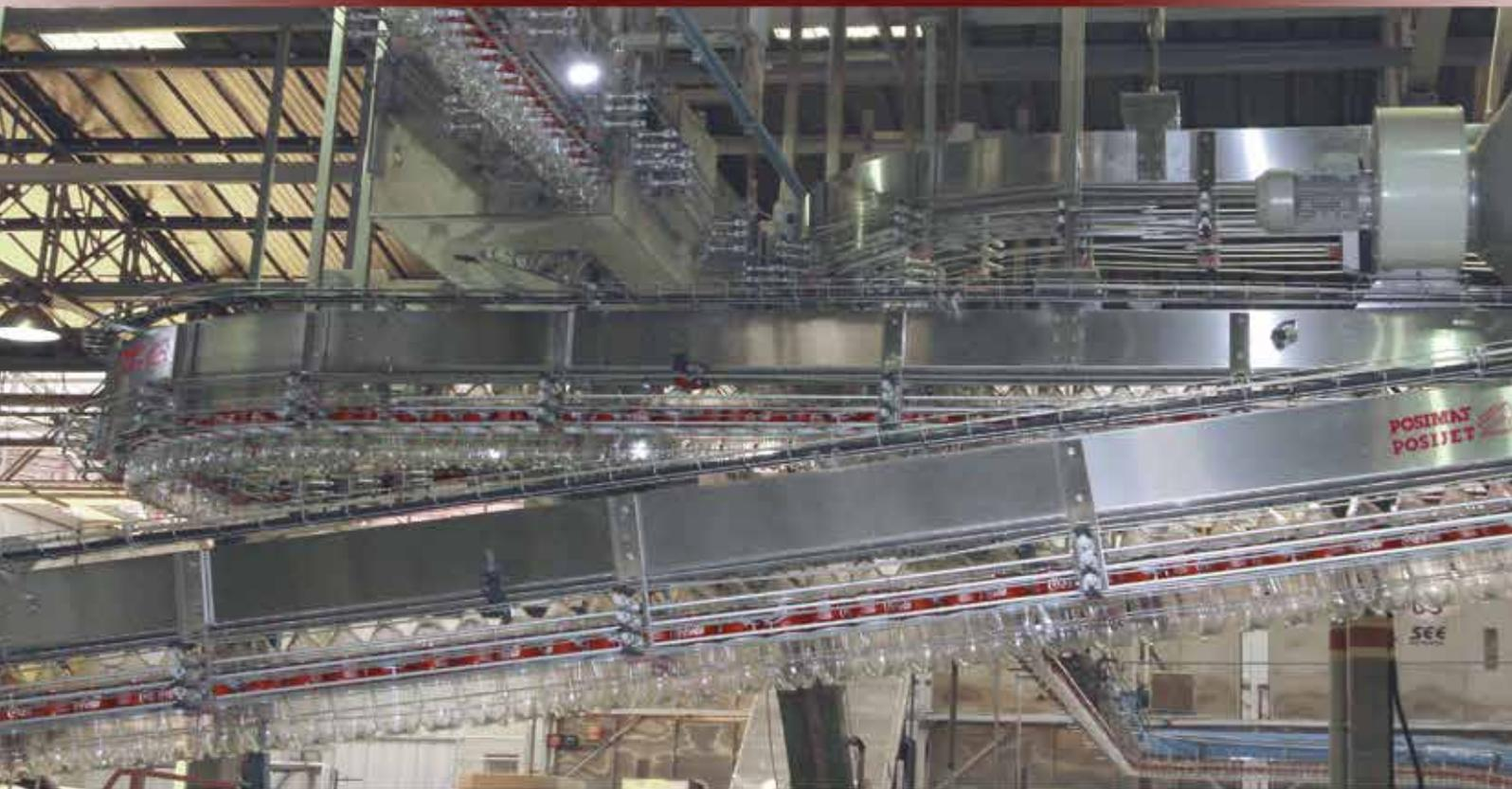
POSIJET是市场上唯一具有双颈导向器的气动输送机。该系统可为易碎的瓶子提供更好的保护和护理，并能将噪音降至最低，在节省能源的同时达到高速运输。在具备这些优点的同时，该系统运输瓶子（从理瓶机或吹塑机运至灌装单元）的性能和效率也丝毫不减。
