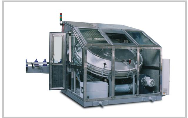
舱室完全封闭，配有带窗的面板和易于进入的舱门，方便进行规格更换、清洁及检查工作。两种饰面可选：涂塑钢或 AISI 304 不锈钢，舱室隔音效果有 80dB(A)，以及效果更佳最高可达 75dB(A) 的选择。
